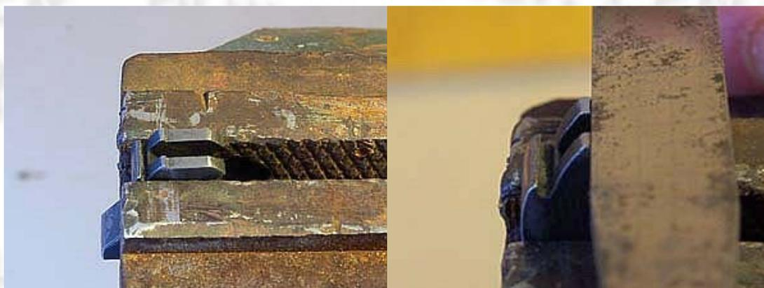
Vu sous l'angle sous lequel on va travailler, on s'aperçoit que les crochets dépassent de la cale. Il suffit ensuite de poser la pierre sur la cale, **bien à l'horizontale**, et de la passer en appuyant vers l'avant, de la soulever pour repartir du point de départ et de la repasser. On aura pris soin de « mouiller » légèrement la cale avec quelques gouttes d'huile que l'on étalera au doigt sur sa surface.
