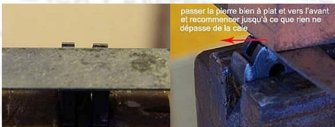
**IMPORTANT** : si on est allé trop loin, si le départ est trop sensible, il est possible, avec la même pierre, de redonner de la hauteur au cran d'armé, cet endroit n'étant pas cimenté. Il suffit de passer la pierre à 90° de la position de la dernière photo, sur la partie sur laquelle repose la cale sur cette même photo.
