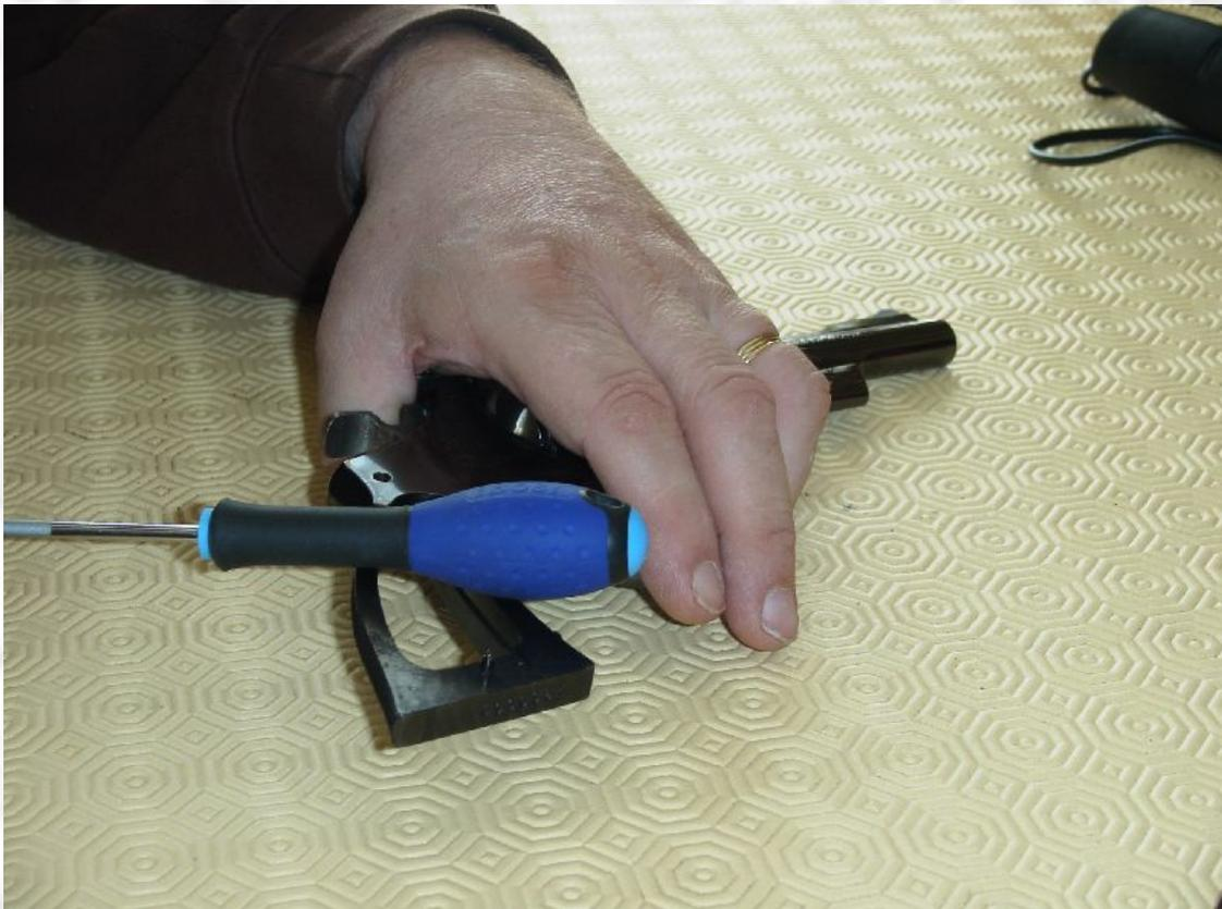
Une fois la platine retirée, on commence par dévisser la vis de mise en tension du ressort principal. Les deux photos qui suivent situent les deux :
