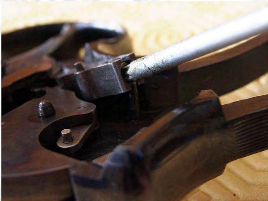
Quand on replace la glissière, remarquez qu'on a enfoncé préalablement le ressort avec le tournevis. Sa partie cruciforme entre dans le ressort lui-même. On peut ainsi le pousser suffisamment pour permettre à l'axe de butée de s'insérer dans la gorge de la glissière, comme on le voit clairement sur la tof. Juste contre la partie inférieure de la tige du cruci.
