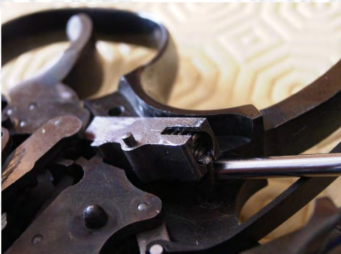
C'est là qu'on met le pouce ou deux doigts (sur l'extrémité de la glissière et le tournevis) pour éviter que la fusée ne s'envole ! Car on soulève maintenant pour de bon et la pièce se dégage (fortement et vivement). Je n'ai pas mis les doigts pour la photo, sinon, il n'y aurait plus rien eu à voir. Ce ressort est le ressort de la glissière de rebond et c'est sur lui qu'on interviendra plus tard éventuellement.
